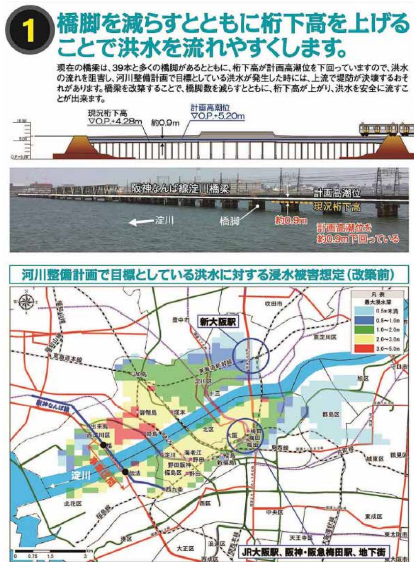
図 3.1 阪神なんば線淀川橋梁改築事業 (淀川河川事務所作成パンフレット (H29.9) より抜粋)
