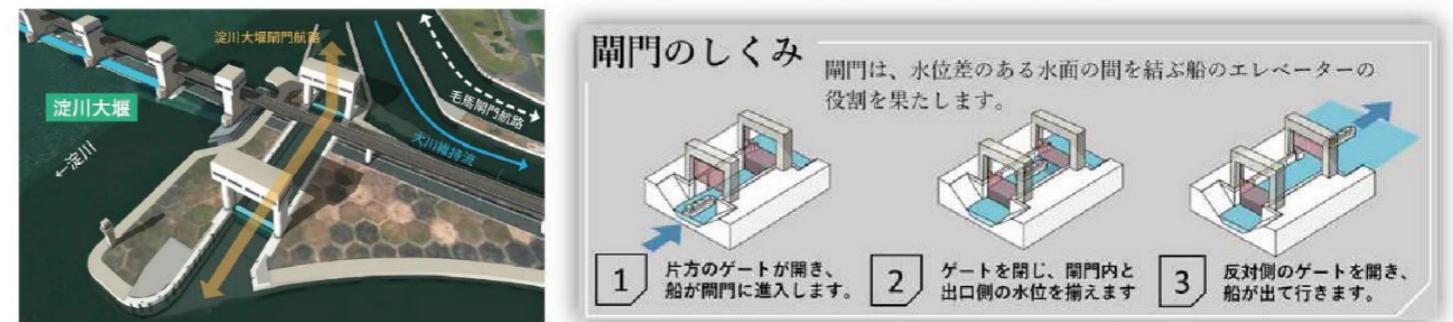
図 4.1 淀川大堰閘門の概要(淀川河川事務所 R6 年度事業概要より抜粋)
